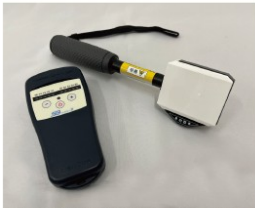
非破壊鉄筋破断検査器「SB テスター」(左)と着磁器
